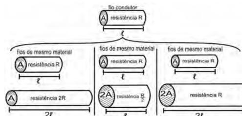
As figuras mostram que as proporcionalidades existentes entre a resistência (R) e comprimento (l), resistência (R) e área da seção transversal (A) e entre comprimento (l) e área da seção transversal (A) são, respectivamente:
